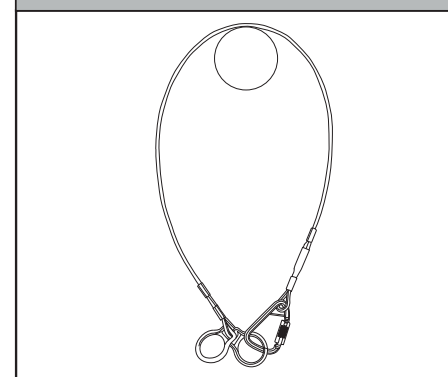
Figure 14 - Installation de l'ancre d'étranglement
